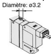
Appuyez sur le bouton de la commande manuelle à l'aide d'un petit tournevis jusqu'à ce qu'il s'arrête. Enlevez le tournevis pour déclencher la commande.
